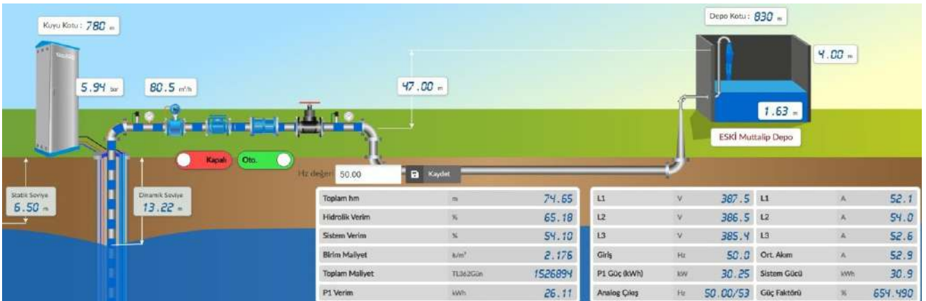
Erken Uyarı ve Otomasyon (SCADA) Sistemi
